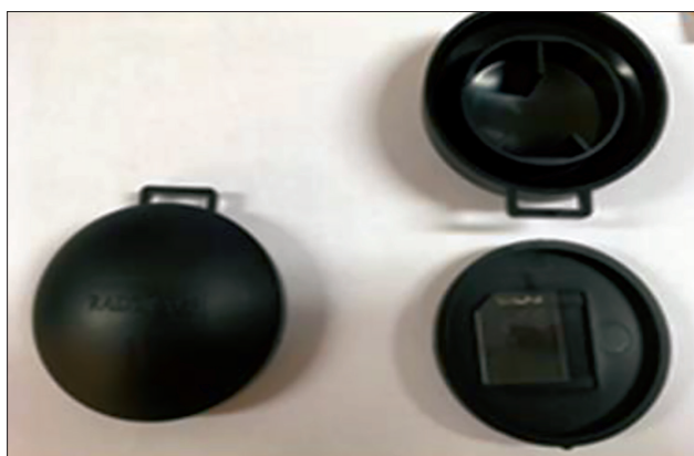
Figura 1. Detector RADTRAK2 de măsurare a concentrațiilor de ^{222}\text{Rn} în locuințe pe termen lung – de la 2 luni până la 1 an.
